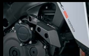
Chránič rámu Pomáhá zmenšit poškození. Je vyroben z hliníku a plastu ertacetal.
