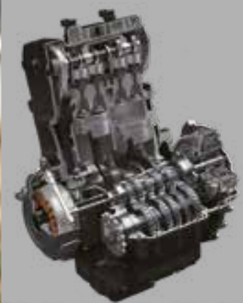
Čtyřdobý řadový kapalinou chlazený dvouválcový motor o objemu 776 cm 3 , DOHC
